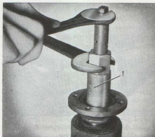
Bild 9. Mont. av medbringare. 1. Pressverktyg, se text
